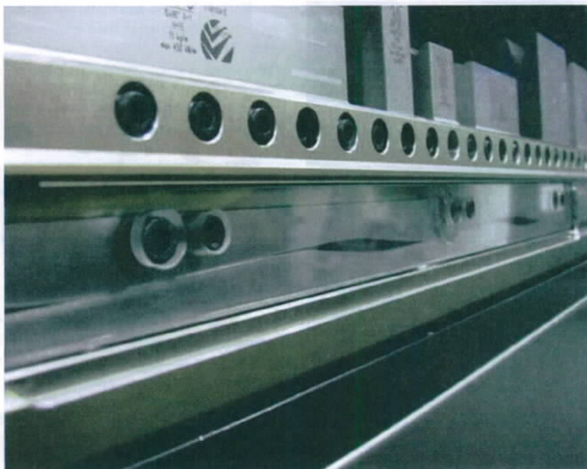
• Op deze foto is duidelijk te zien hoe het bombeersysteem van Wila werkt. De onderlinge positie van twee 'gegolfde' stalen balken wordt door de motorreductor veranderd, waardoor de doorbuiging van de onderbalk tijdens het zetten wordt gecompenseerd. Het resultaat is een over de gehele plaatlengte gelijke buighoek.
